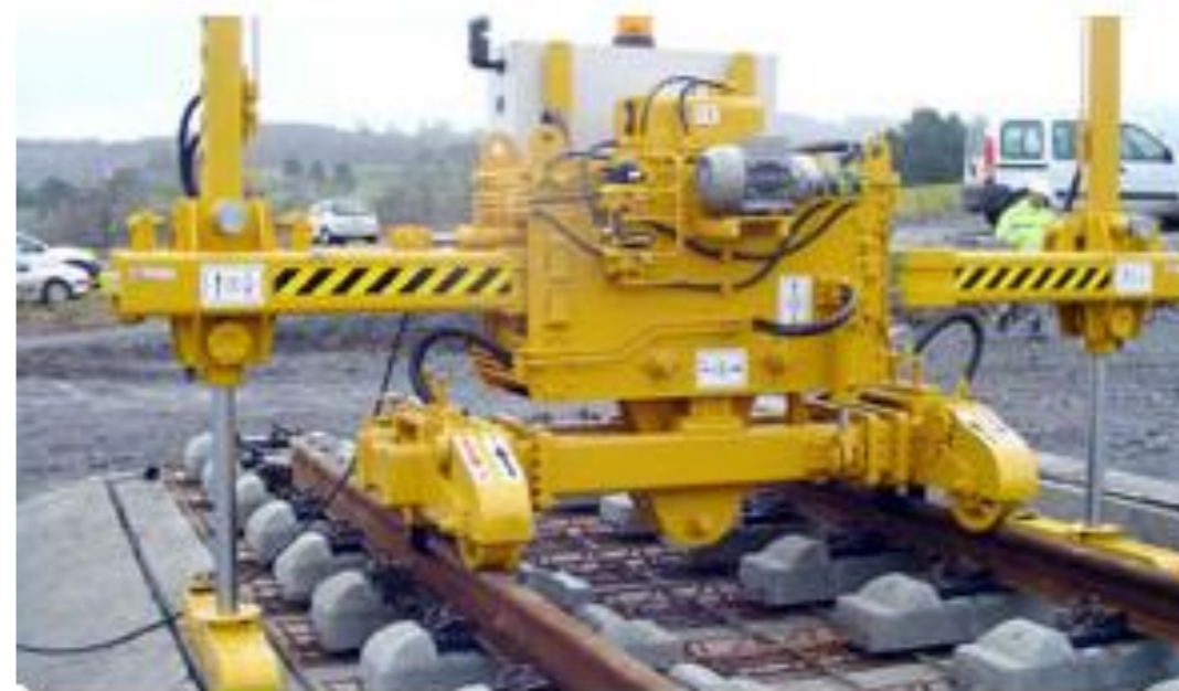
Figura 5. Pórtico de nivelación
