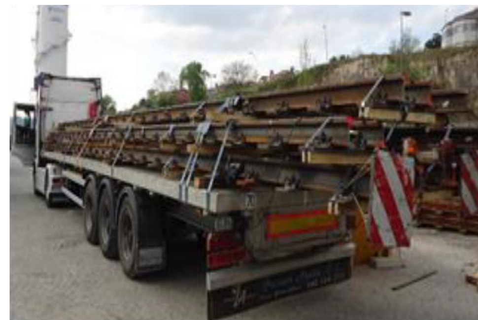
Figura 14. Transporte de aparato de vía por carretera
